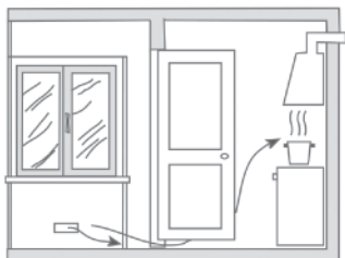
Забезпечення необхідного зазору між дверима приміщення та порогом для вільного проходу приливної повітря
